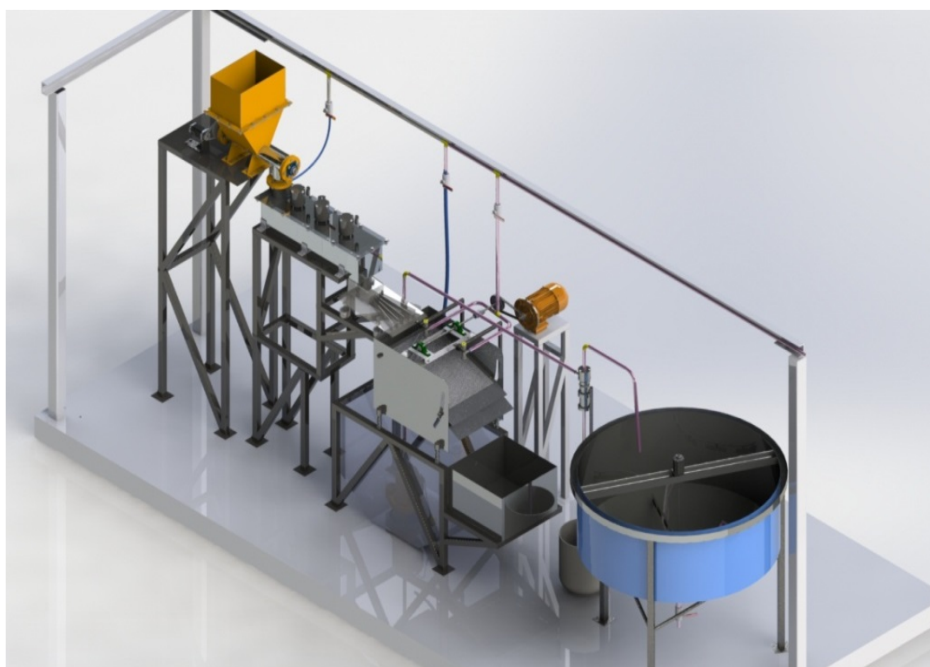
Figura 1. Planta piloto para el procesamiento de Caolín.
