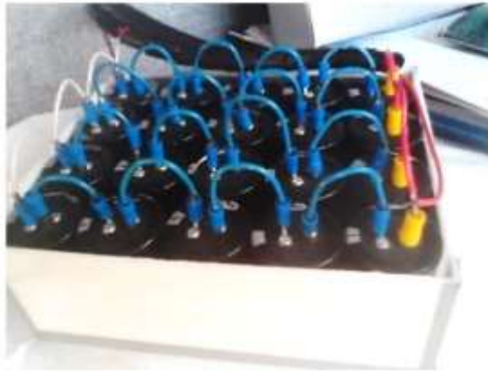
Ilustración 14. Agrupación del banco de capacitores.
