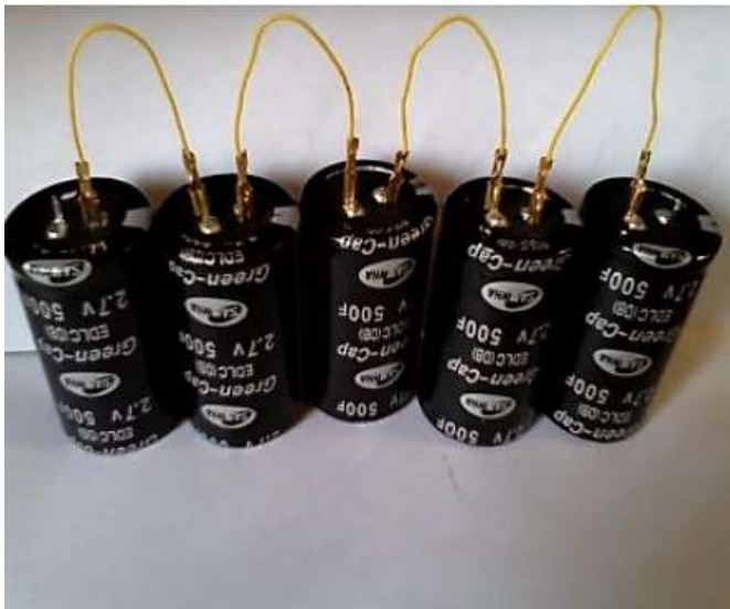
Ilustración 11. Conexión de ultracapacitores en serie.
