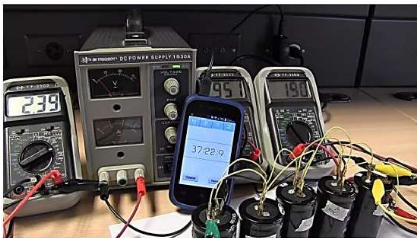
Ilustración 13. Circuito de carga y descarga con los ultracapacitores en paralelo.
