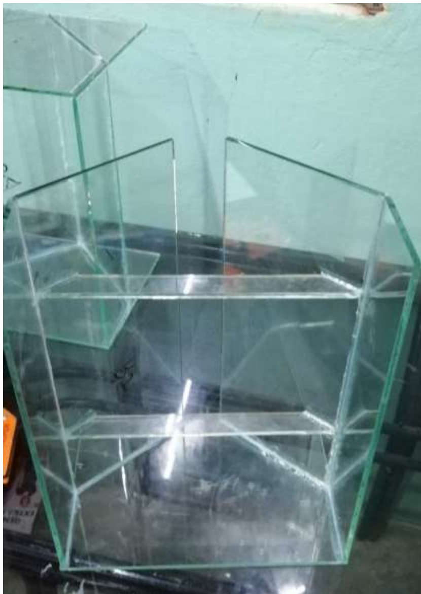
Ilustración 34 Anexo foto de la fabricación del destilador solar.
