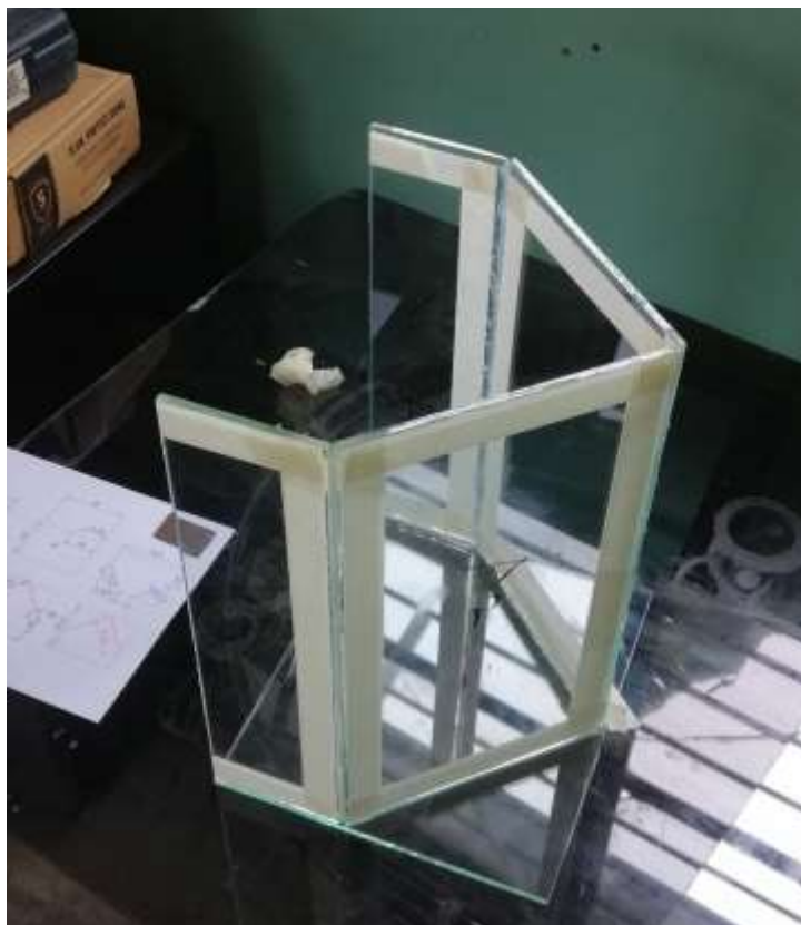
Ilustración 29 Anexo foto de la fabricación del destilador solar.
