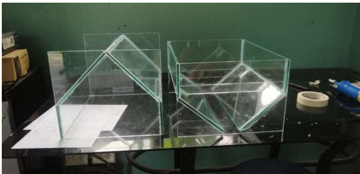
Ilustración 36 Anexo foto de la fabricación del destilador solar.
