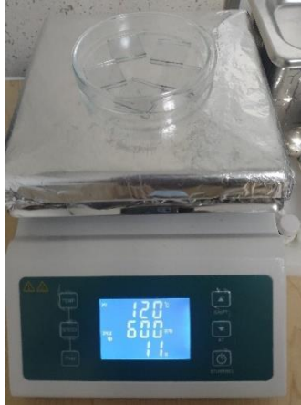
Figura 19: Recocido de las películas de PEDOT: PSS
