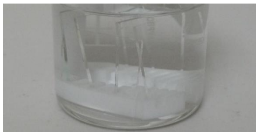
Figura 16: Limpieza de los substratos
