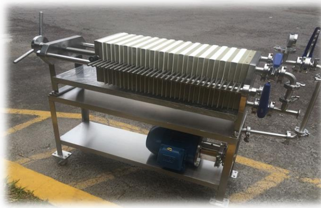
Figura9. Filtro prensa utilizado para eliminar sedimentos y darle brillo a la cerveza
