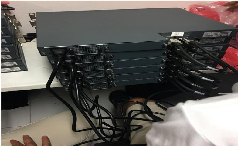
Antes de cualquier configuración que se pretenda realizar es importante probar que el dispositivo esta en óptimas condiciones para poder empezar todo el trabajo, así que se testeó puerto por puerto de cada switch de esta primera parte de dispositivos que se deben implementar del site principal.
