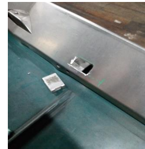
Imagen 5 Área de sensor cortada
