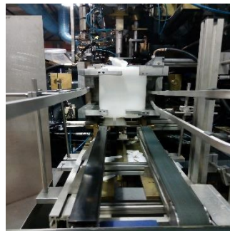
Imagen 26 Rebabeadores que cortan la colada en la máquina
