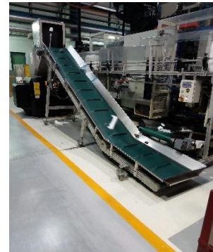
Imagen 22 Banda arrastrando coladas hacia el molino
