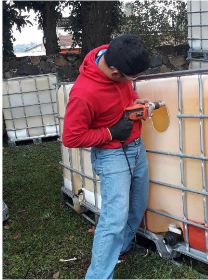
Figura 3.3 corte de termo
