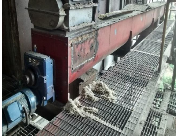
Ilustración 16 Transportador helicoidal caldera N°15.
