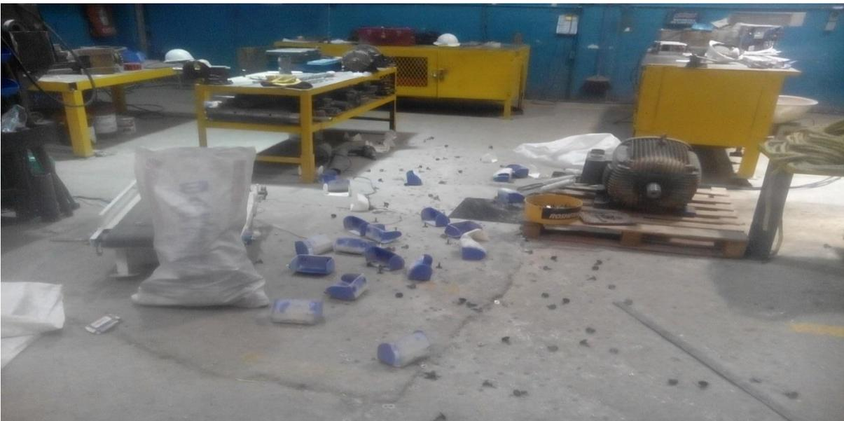
Evidencia 5, En estas imágenes se muestran como esta desordenado el área después de que se realiza un trabajo de mantenimiento correctivo así como también la colocación de diésel y gasolina en recipientes inadecuados.
