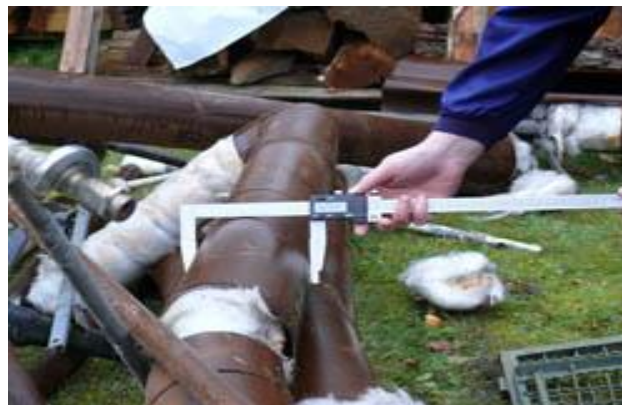
Ilustración 1: Simbólica De Medición De Diámetro De Tubería
