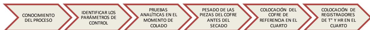
Figura 1. Pasos a seguir para la realización del proyecto, antes de iniciar receta
