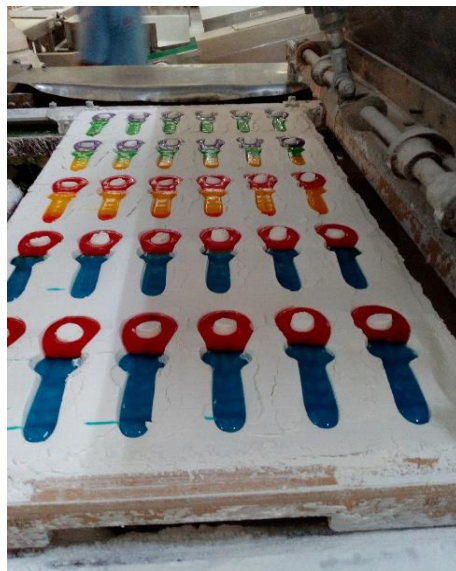
Figura 5. Mega gummy pop saliendo del inyector de goma.
