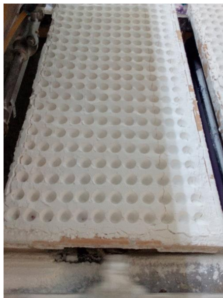
Figura 10. Cofre con los moldes de almidón.
