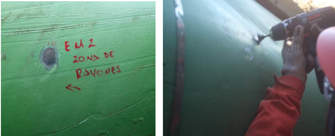
Ilustración 12 Preparación de la zona a inspeccionar.
