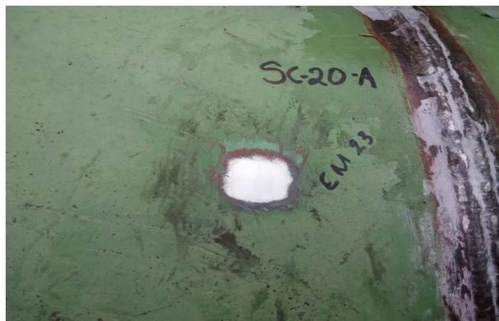
Ilustración 13 Obtención del acabado espejo.
