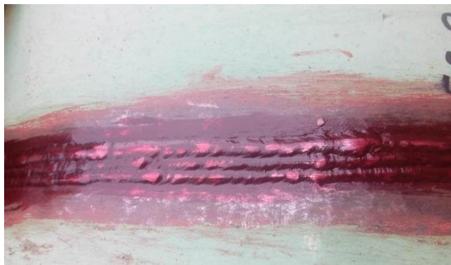
Ilustración 6 Aplicación de penetrante.
