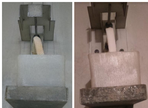
Ilustración 44 Mecha sucia lado izq. mecha limpia lado der.
