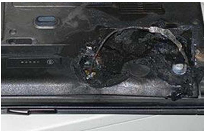
Figura 3.2.1 parte dañada de un controlador
