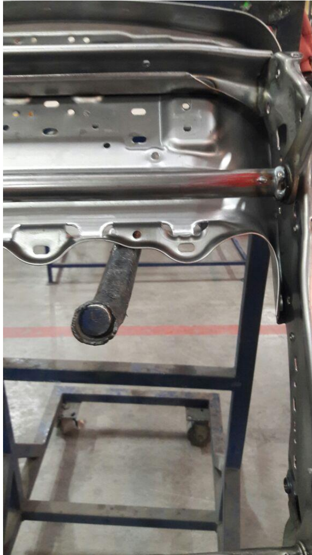
Imagen 4. Mala calidad del cordón
