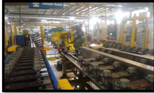
Ilustración 15: Proceso de recocido.
