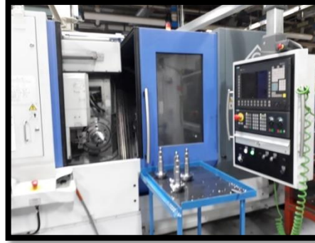
Ilustración 7: Batería CNC de corte de diente.
