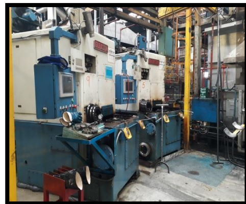
Ilustración 14: Templeado en prensa.
