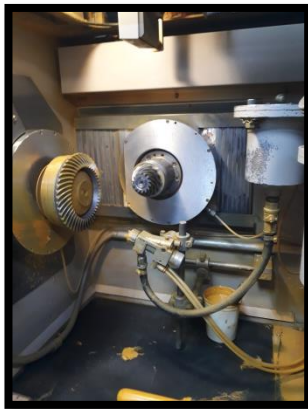
Ilustración 10: Proceso de lapeado.
