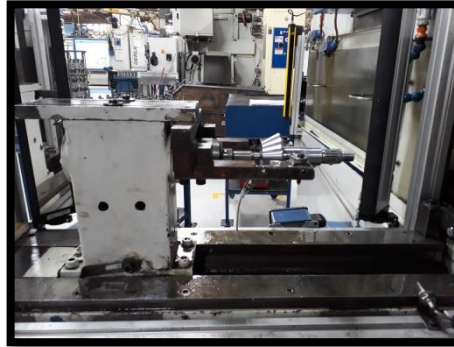
Ilustración 5: Proceso de rolado.
