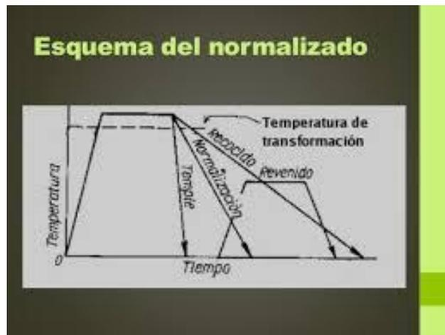
*Ilustración 5. Esquema de tratamiento térmico.*
