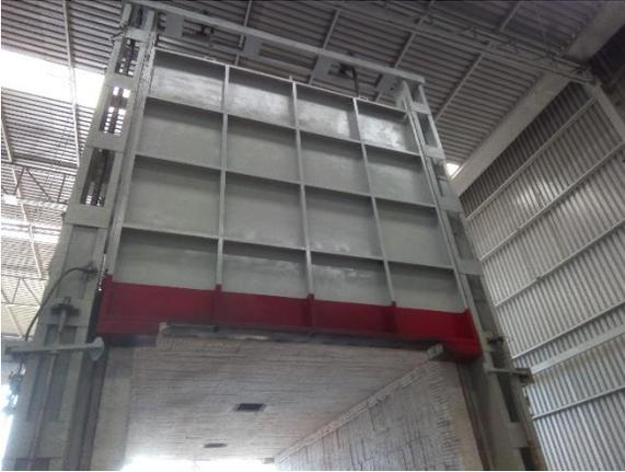
*Ilustración 35 puertas de horno carbottom-002.*
