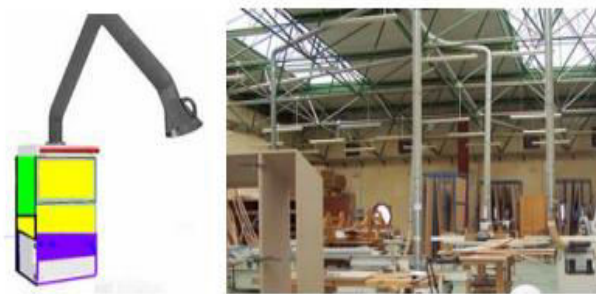
Ilustración 1. Sistema de extracción ramificado y simple
