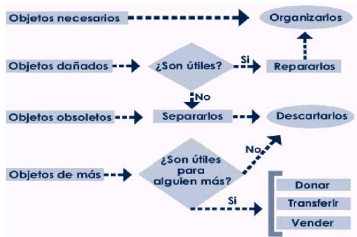
Diagrama 3.- Diagrama de flujo para la clasificación de equipos, herramientas y elementos, utilizado únicamente como referencia para la clasificación en dos categorías, necesario e innecesario
