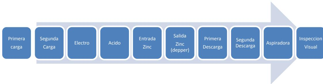
*Diagrama 1.- Distribución de las estaciones de trabajo. Se aprecian un total de nueve estaciones de trabajo para operarios y una estación para inspección visual, que siguen un flujo continuo asemejando el proceso de producción de la línea de Zinc.*
