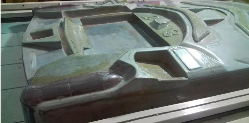
**Imagen 1.4.2** molde de madera para termoformar
