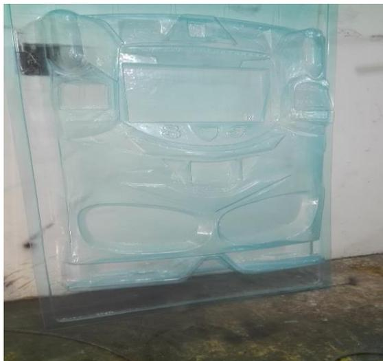
**Imagen 1.4.3** tapa termoformada de plástico PETG
