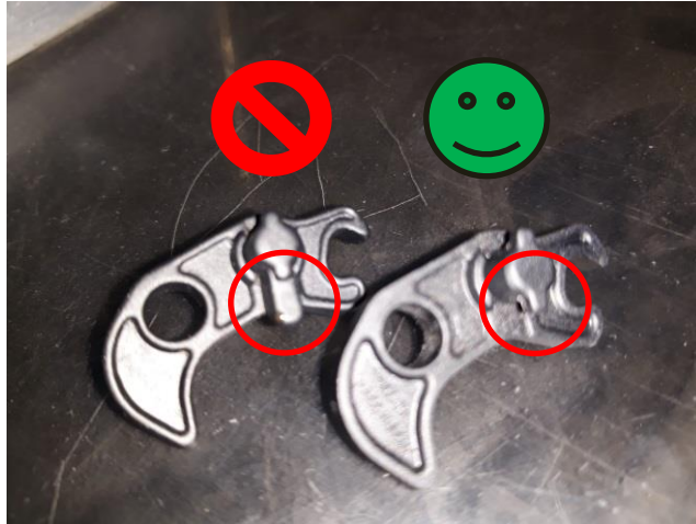
Ilustración 11. Spacer con rebaba.
