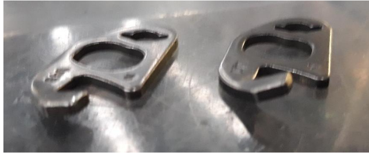
Ilustración 21. Levas en mal estado encontradas en la Cuba de la 2.5.
