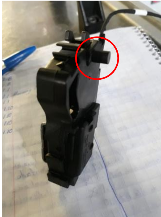
Ilustración 10. Housing con rebaba.
