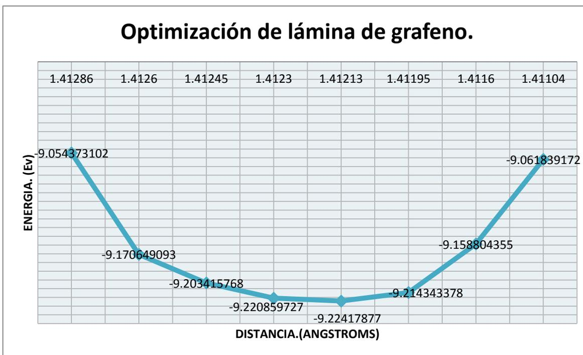
Ilustración 13. Optimización de lámina de grafeno.
