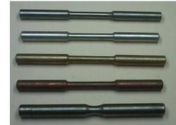
Figura 4. Probeta s con diferente porcentaje de carbono para pruebas de tratamiento térmico.
