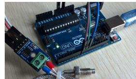
Figura 1. Módulo sensor de temperatura termocupla con Arduino.
