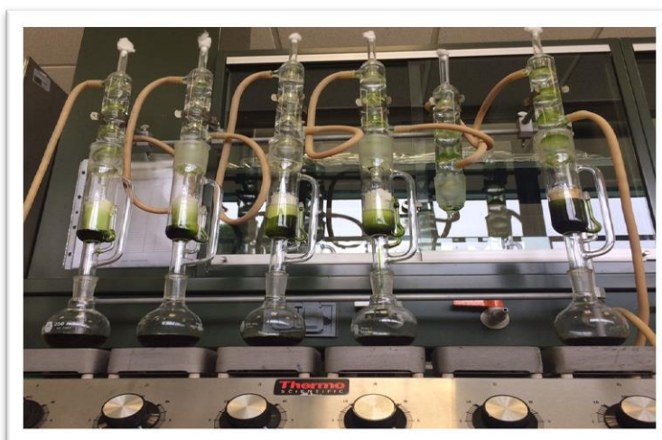
Figura 2. Extracción de Zacate ( Cymbopogon citratus ) por maceración.
