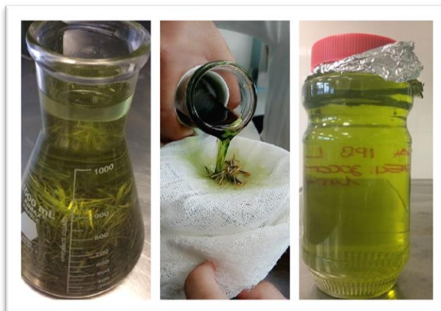
Figura 2. Extracción de Zacate ( Cymbopogon citratus ) por maceración.
