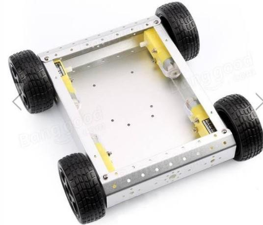
Lleva incorporados 4 motorreductores DC de 3-6 V 125-230 rpm 100-150 mAh y una fuerza de torsión de aproximadamente 0.8 kg c/u. ruedas de plástico lo cual mantiene al vehículo aislado.
