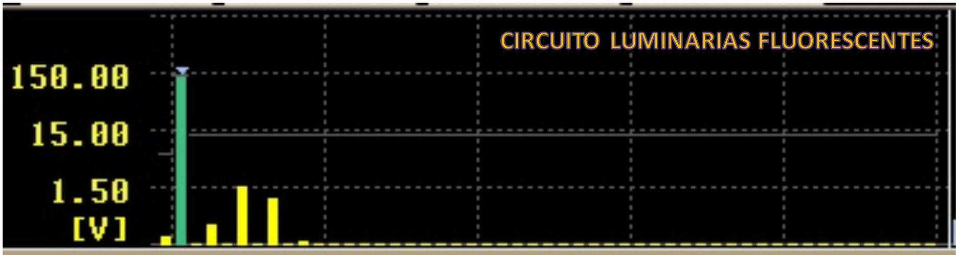
**Fig. 8 Distorsión de las señales de voltaje/corriente**
