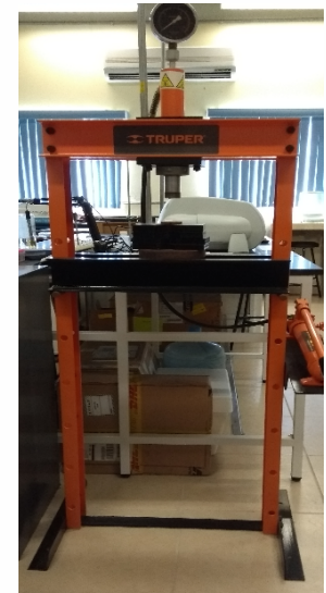
Prensa Hidráulica tipo H Marca truper.
