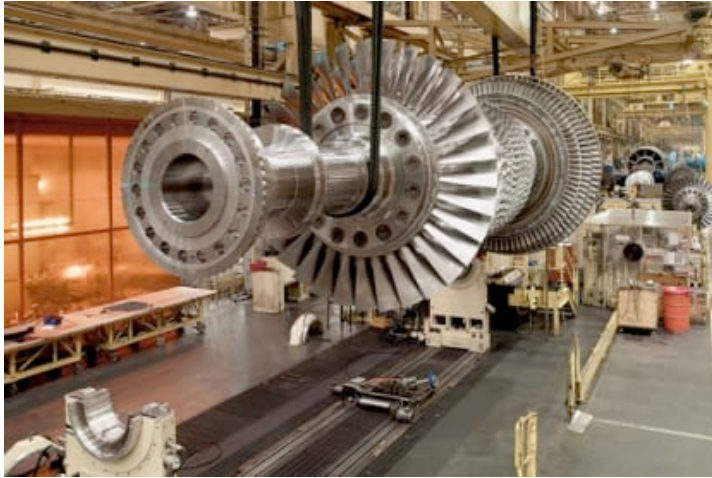
Figura. 1. Turbina de gas
