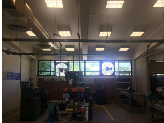
Figura 3. Taller de manufactura. Se puede apreciar la luz natural mezclada con la luz artificial de las lámparas Fluorescentes T8.
