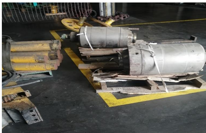
Ilustración 5 Repuesto en pasillo salida de emergencia
