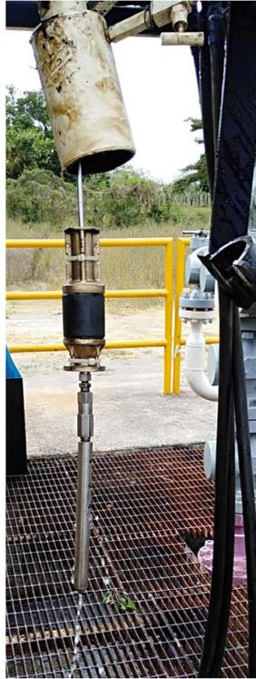
*Figura 5.-Difusor de tubería capilar*
