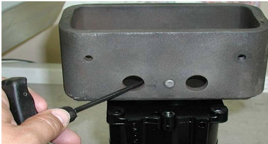
*Figura 13.-Remplazando la rueda excéntrica*
