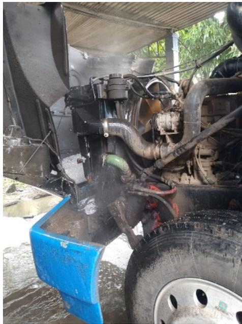
*Ilustración 7 Lavado exterior del radiador*
