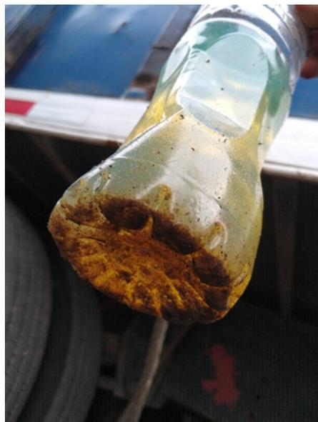
*Ilustración 5 Diésel sucio obtenido del drenado de tanques*
