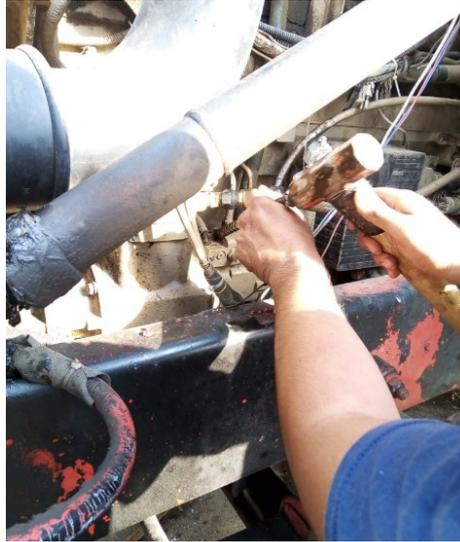
*Ilustración 6 Cambio de cedazo de bomba de combustible*
