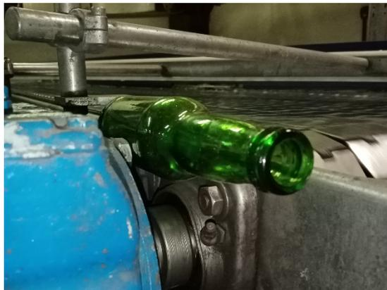
Ilustración 2: botellas enteras en los transportadores atoradas
