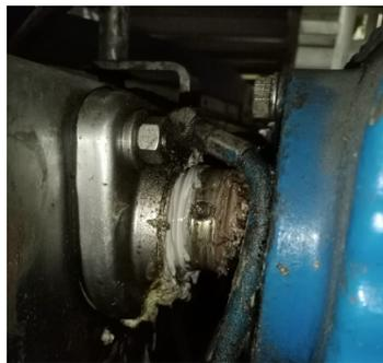
Ilustración 5: Excesos de grasa por un mal control de la lubricación
