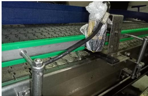
Ilustración 8: Sensor de acumulación con recubrimiento de plástico
