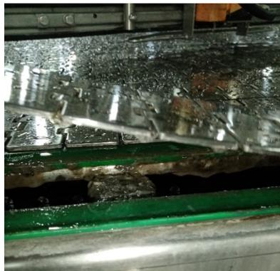
Ilustración 23: Áreas con exceso de contaminación externa
