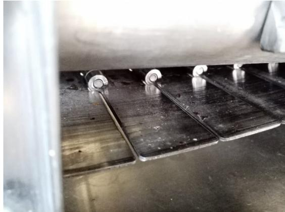
Ilustración 25: Eslabones con rayado e incrustaciones por vidrio triturado
