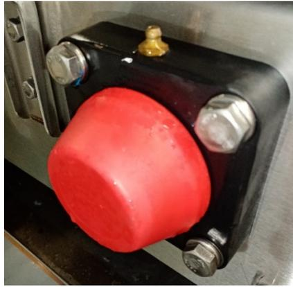
Ilustración 20: Chumacera con protección que evita la introducción los químicos usados en la limpieza y contaminación por polvos
