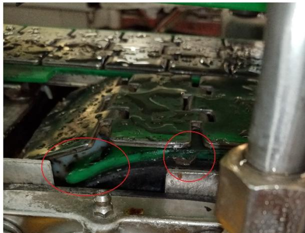
Ilustración 16: Acumulación de biomasa y vidrio después de una limpieza cosmética
