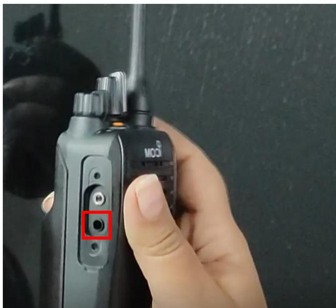
*Figura 66. Puerto de accesorios radio portátil ICOM*
