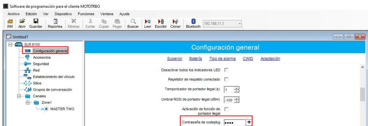
Figura 26 Configuración general repetidor - Contraseña
