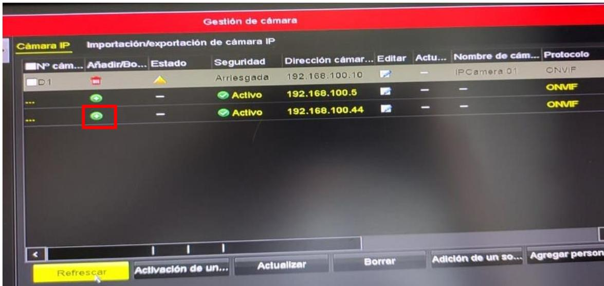
Figura 107 Detección de la cámara PTZ
