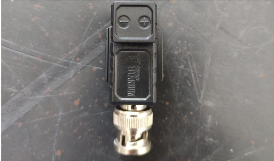
*Figura 75 Transceptor para videocámara*
