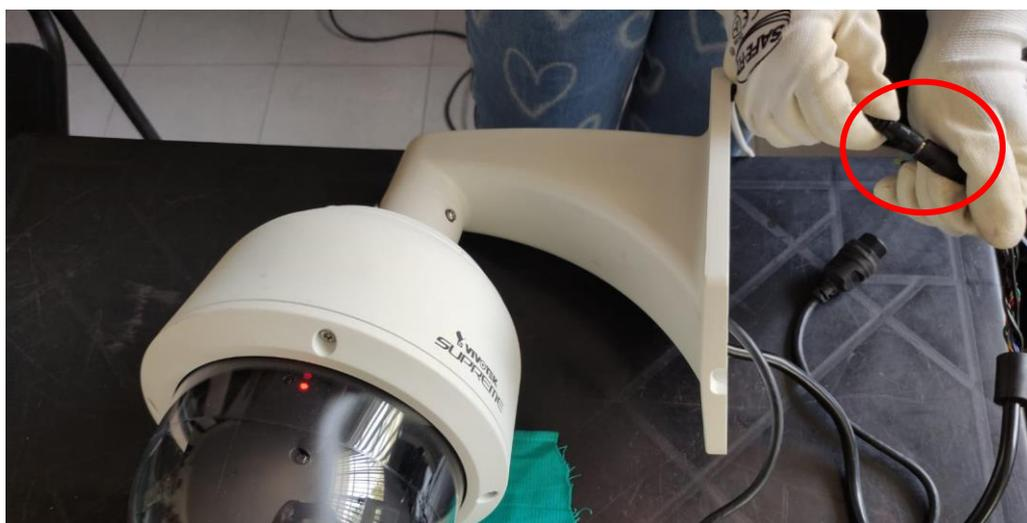
Figura 101 Conexión de alimentación PTZ
