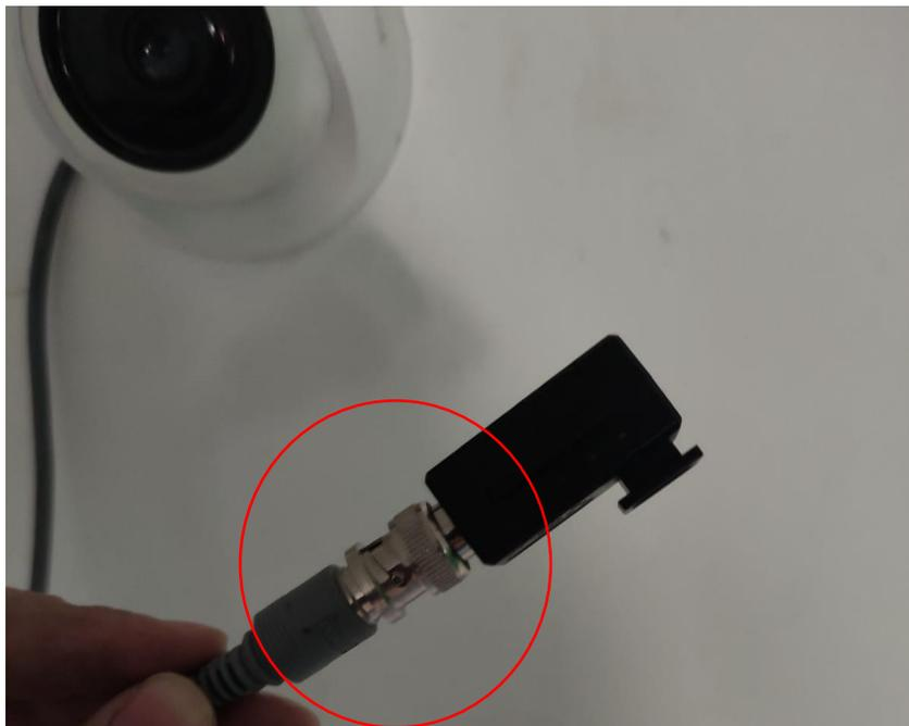
*Figura 76 Conectar transceptor a cámara 1 – MATRIZ*
