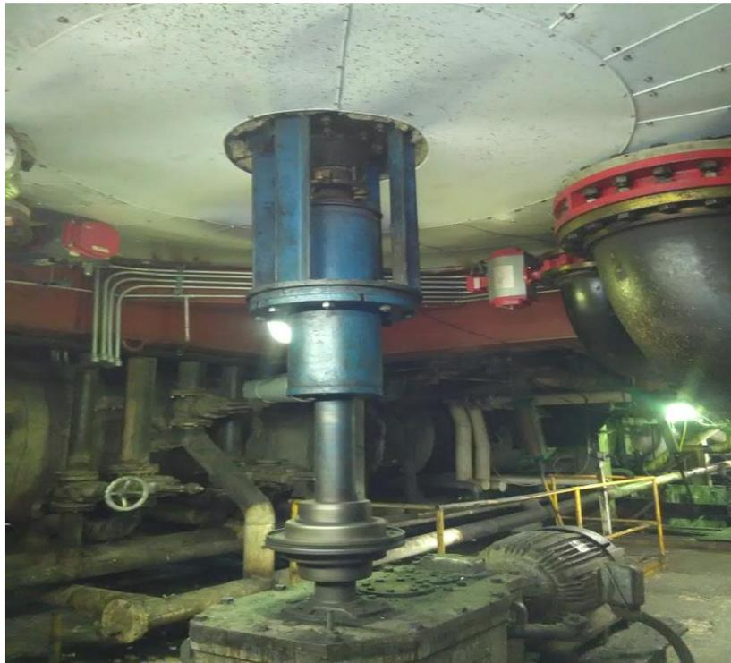
Fig. 3.6 Motor y transmisión mecánica del agitador del tacho.
