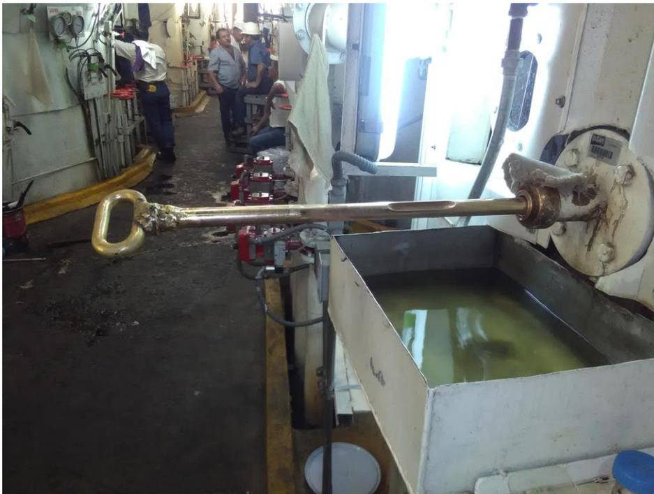
Fig. 3.2 Sonda para extraer muestras de forma manual.
