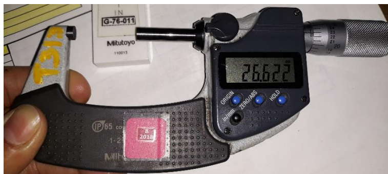
Fig. 12 Micrómetro de 1-2" no presenta oxidación ni golpes.
