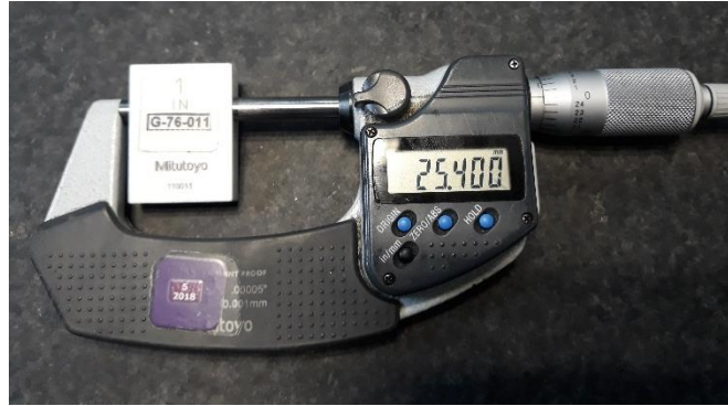
Fig. 13 Micrómetro digital de 1-2" ajustado a 1 in con el blog patrón.
