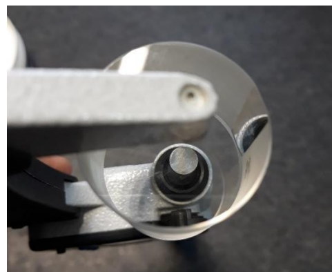
Fig. 15 Verificación del paralelismo del micrómetro.
