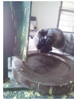
IMAGEN 3 Y 4. BASE PARA CABECEO LIMPIA Y LUBRICADA.
