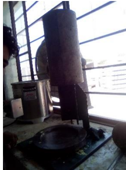
IMAGEN 5. CILINDROS DE CONCRETO EN POSTURA PARA CUBRIR LA PRIMERA CARA CON AZUFRE.
