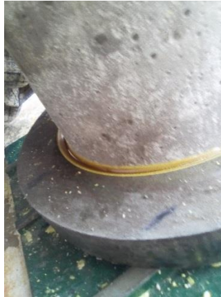
IMAGEN 7. CILINDROS DE CONCRETO CABECEADO CON AZUFRE LÍQUIDO, REPOSO DE ENFRIAMIENTO Y ENDURECIMIENTO DEL AZUFRE.
