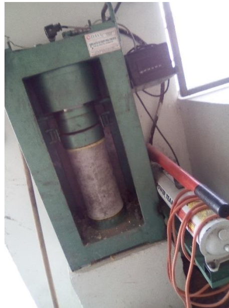
Fig. 2 Prensa Hidráulica, para pruebas de compresión.
