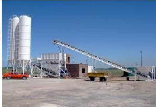
IMAGEN DE LA DOSIFICADORA, DONDE SE ELABORA LA MEZCLA PARA LA ELABORACIÓN DE CIERTOS PRODUCTOS.
