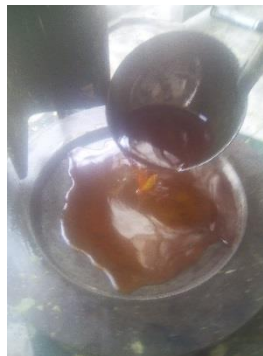
IMAGEN 6. AGREGADO DE AZUFRE LIQUIDO EN PLATO DE CABECEO.
