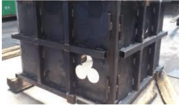
IMAGEN DE UN MOLDE PARA LA ELABORACIÓN DE UN REGISTRO CON CONDICIONES POR CFE.
