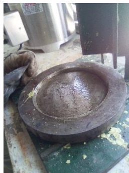
IMAGEN 3 Y 4. BASE PARA CABECEO LIMPIA Y LUBRICADA.
