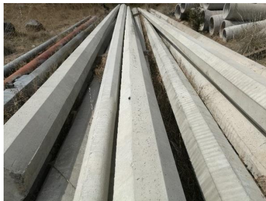
IMAGE DE UN POSTE EN PROCESO FINAL Y ESTIBADO.
