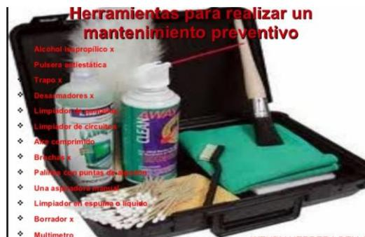
Ilustración 7 Ejemplo de material-herramienta para mantenimientos preventivos
