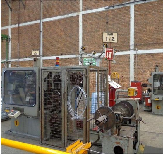
**Imagen. 1.0** Maquina de Púas Alta resistencia (PAR).
