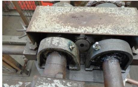
**Imagen 1.2** Chumaceras desgastadas de la maquinaria de Púa Alta Resistencia (PAR).
