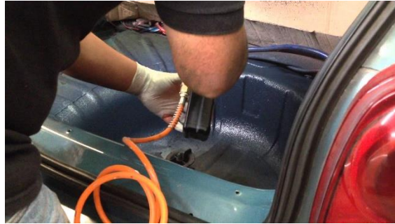
Fig. 5 Protección por pintura
