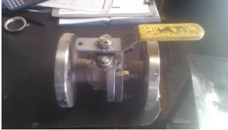
Imagen 3.5 valvula de bola (apollo) ya con armada y con empaques nuevos
