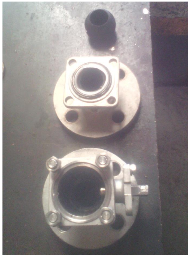
Imagen 3.4 válvula apollo en mantenimiento
