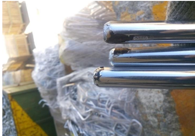
Ilustración 2 Puntas con desprendimiento de cromo
