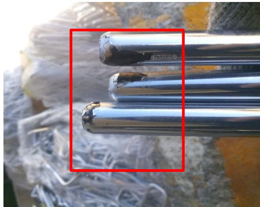
Ilustración 6 Desprendimiento de cromo
