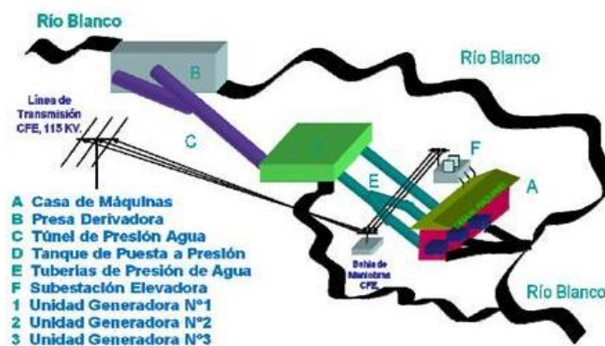
Figura 3. Complejo de la central hidroeléctrica "Santa Gertrudis" (Fuente: PROENERMEX S.A. de C.V.)
