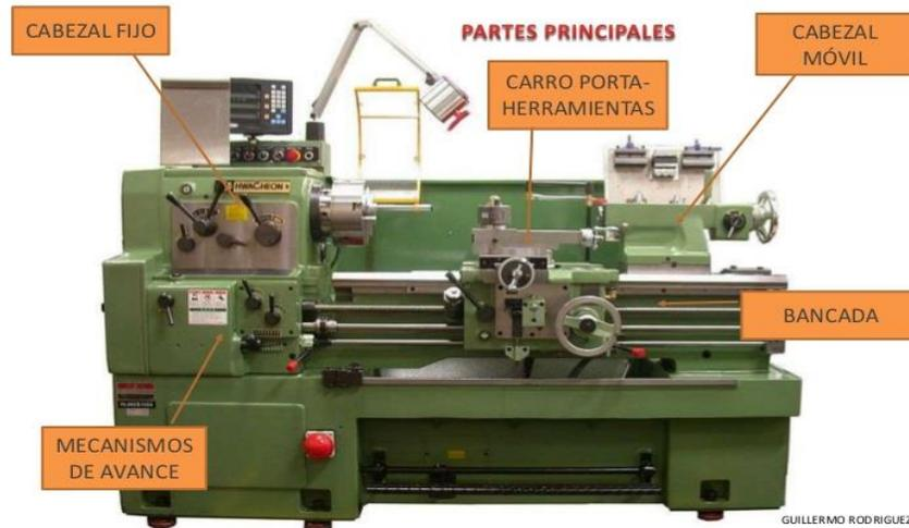
Ilustración 1.2 Partes importantes del torno.
