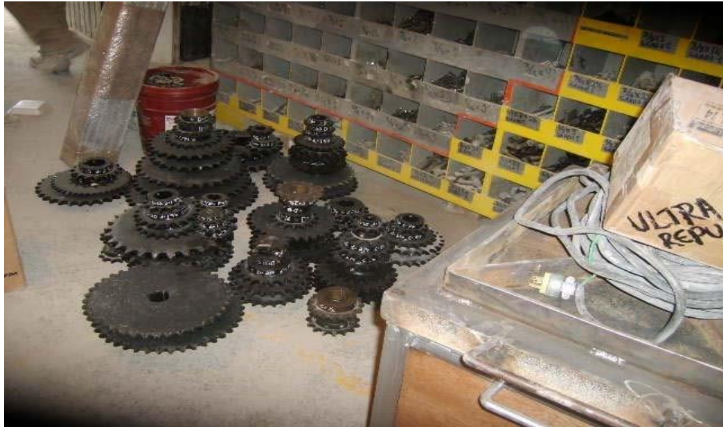
Imagen 12. Forma Incorrecta del Acomodo de las Catarinas Obstruyend o el Paso.
