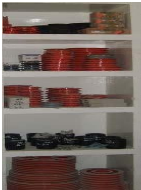
Imagen 16. Forma incorrecta de las Poleas sin Identificación
