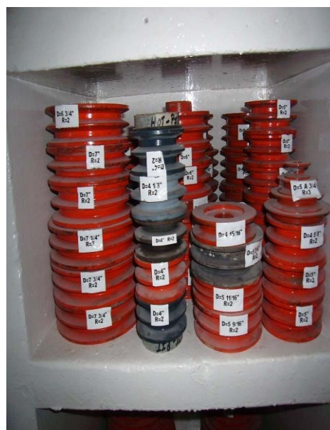
Imagen 16. Forma incorrecta de las Poleas sin Identificación
