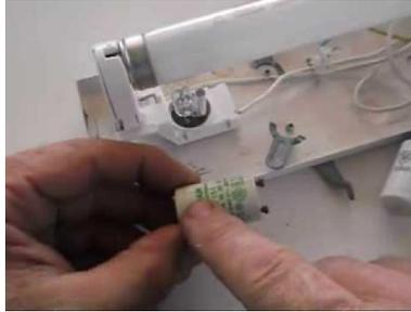
Figura 2.10: Ejemplo de cebador para lámpara de tubo.
