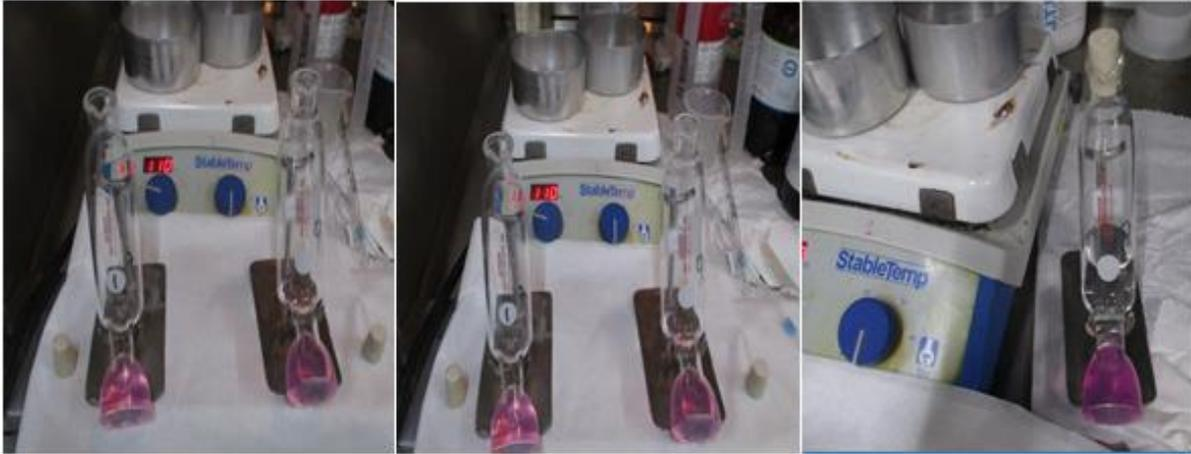
Fig. 32 Extracciones en el análisis de extracción de grasa en las muestras de LDP.
