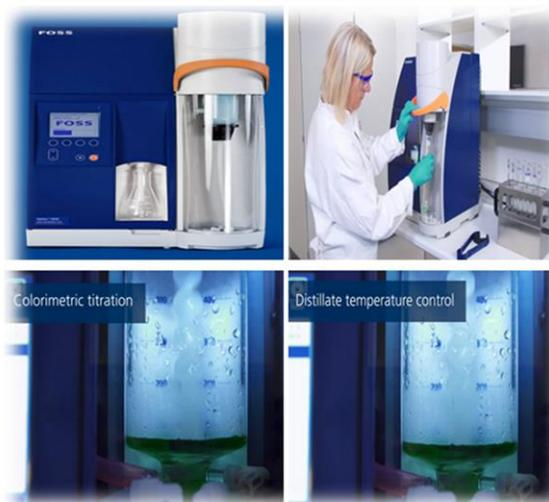
Fig. 19 Etapas que se realizan en la unidad de destilación del equipo Kjeldahl
