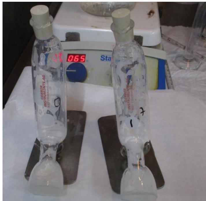
Fig. 31 Agitación constante en el análisis de extracción de grasa en las muestras de LDP.
