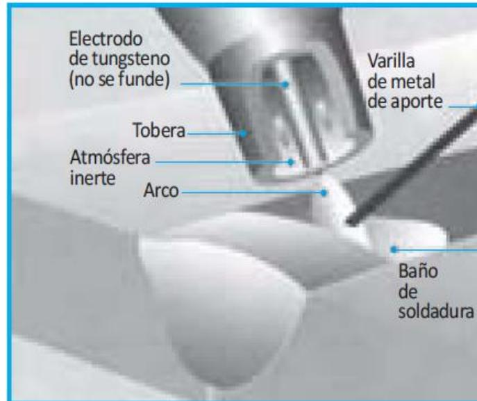
Figura 18. Proceso de soldadura TIG.
