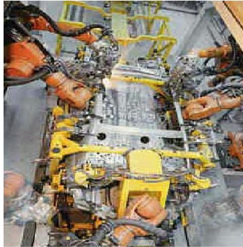
Figura 20. Robots soldando en una línea de ensamble
