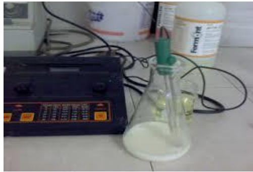
Figura 16. Potenciómetro con leche.
