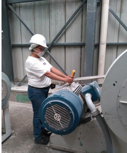
Imagen 13 Medición de vibración en M5NGRE
