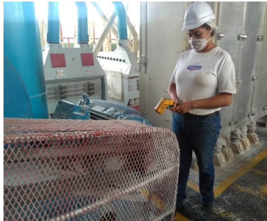
Imagen 10 Medición de temperatura a M4NGE
