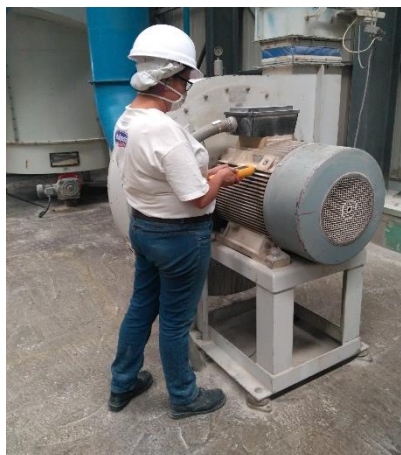
Imagen 15 Medición de vibración M5NGOE
