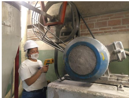
Imagen 10 Medición de temperatura a M4NGE
