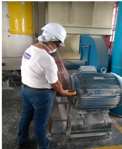
Imagen 13 Medición de vibración en M5NGRE
